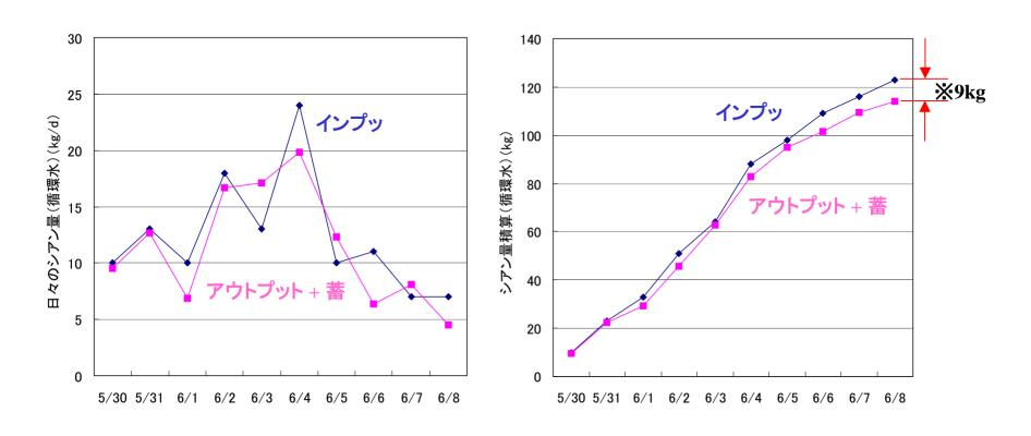
※「インプット」と「アウトプット+蓄積」の差は機器への付着シアン量と推定される。
