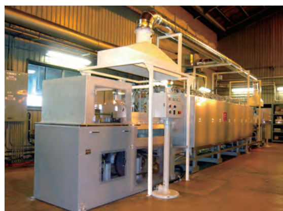
実機仕上還元条件を再現できる熱処理炉
