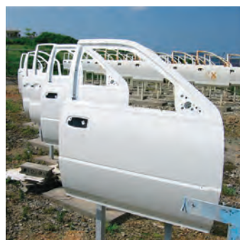
実車ドア部品の暴露試験 (沖縄)
