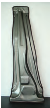
超ハイテン適用骨格部品 1180MPa 材適用 センターピラー
