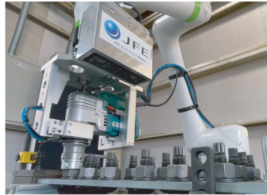
写真1 平板試験体を用いた実証試験
