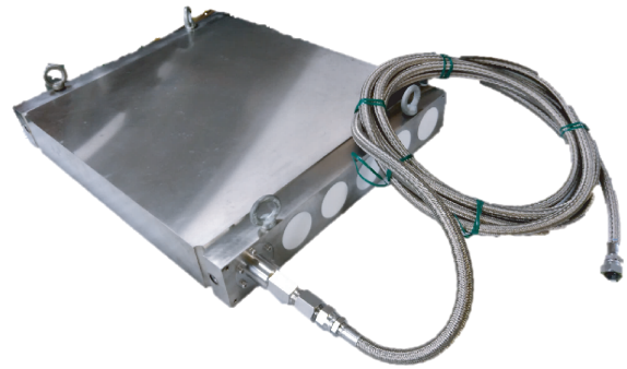
写真 1 20 MN 角形ロードセル Photo 1 20 MN slab type load cell
