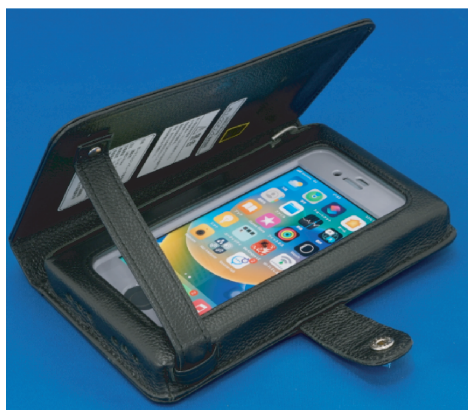
写真2 防爆スマートフォン Photo 2 Explosion-proof smart phone
