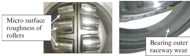
写真1 ベアリング損傷例 Photo 1 Bearing wear
