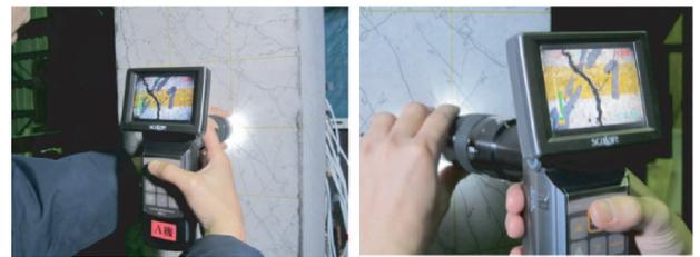
写真2 せん断ひび割れ幅測定状況
