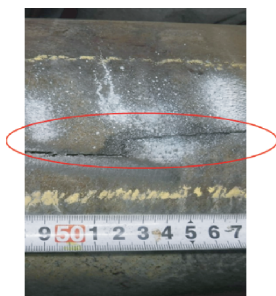
写真1 水冷による冷却割れビレット写真 Photo 1 Cracked billet by water-cooling
