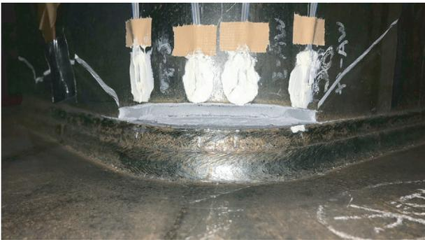
写真4 コラム角部の破断
