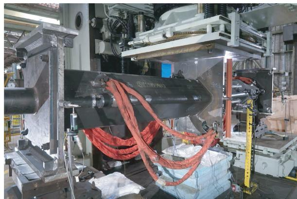
写真 3 3 点曲げ試験の様子
