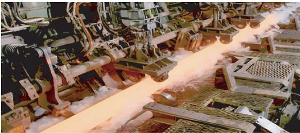
写真1 シームレス鋼管の急速冷却時の外観図
