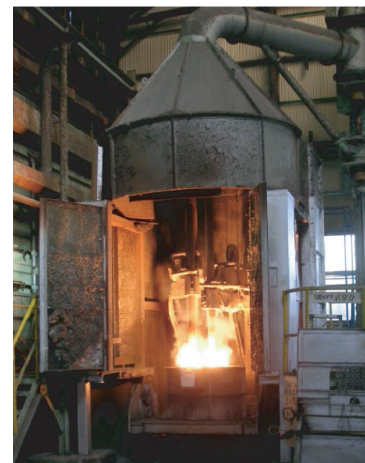
写真 1 電気炉による MnO 2 の還元
