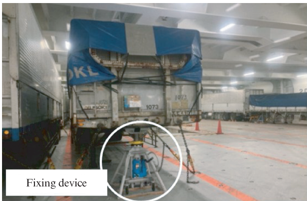
写真4 フェリー船内のシャーシ積み込み状況 Photo 4 Chassis loading on board ferry
