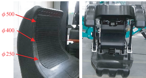
写真4 パイプ径毎の掴み位置における凹み
