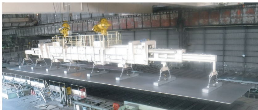
写真1 長尺用クレーン外観写真
