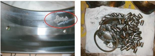
写真1 軸受損傷状況
