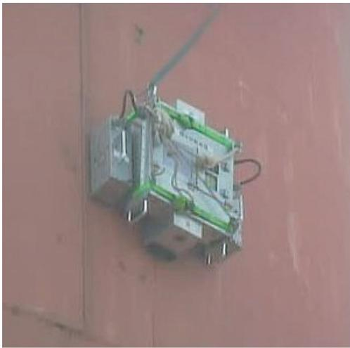
写真 2 煙突を診断する本開発装置
