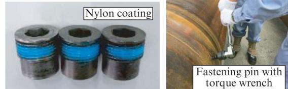
写真3 逆回転防止ピンの緩み止め防止策
