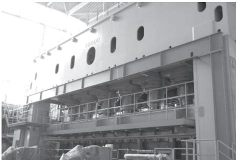
図5 高能率型プレスバンド用プレス装置 (NEOプレス®)
