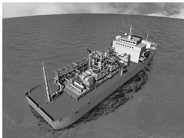
図 2 洋上出荷基地向けタンカー排出ガス回収設備
