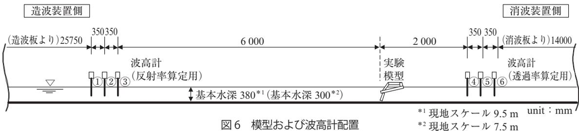
図6 模型および波高計配置
