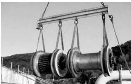
写真1 超音波ピグ Photo 1 Ultrasonic tool
