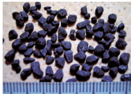
写真1 被覆造粒炭の外観写真
