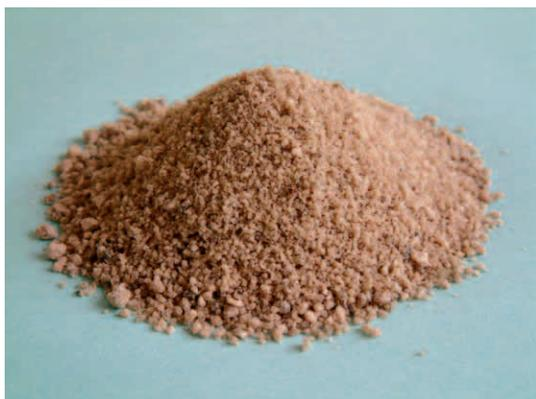
写真1 高炉スラグ細骨材 (JFE ミネラル京浜製造所産)
