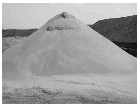
写真1 固結防止剤を添加した高炉スラグ細骨材の屋外貯蔵試験
