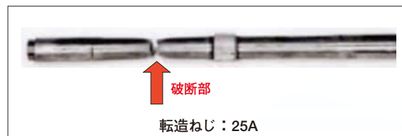
引っ張り試験後の状態
