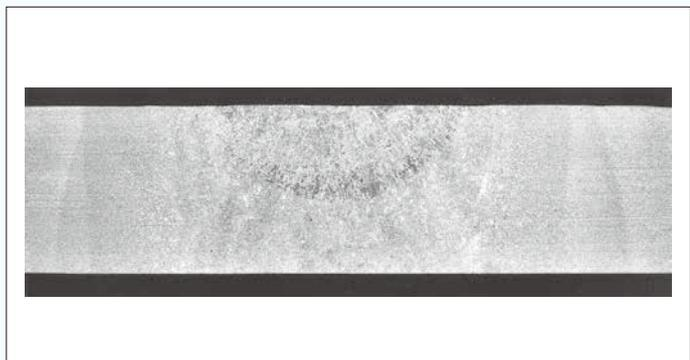
UOE 鋼管の腐食試験後の断面マクロ
