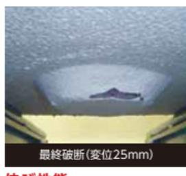
最終破断 (変位25mm)
