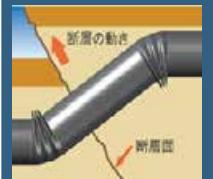
地震発生時に大きな地盤変状が想定される箇所に使用します。
