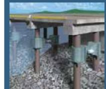
桟橋上部工に手を加えずに補強が可能な工法です。
