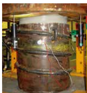
管内リングと球根の付着試験
