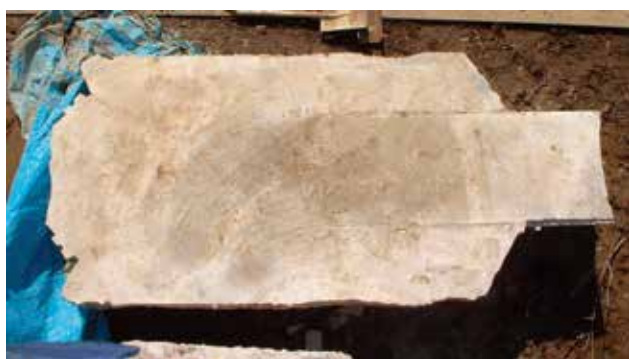
拡大球根の切断による確認
