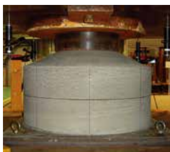
管外突起と球根の付着試験
