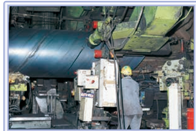
スパイラル 鋼管製造
