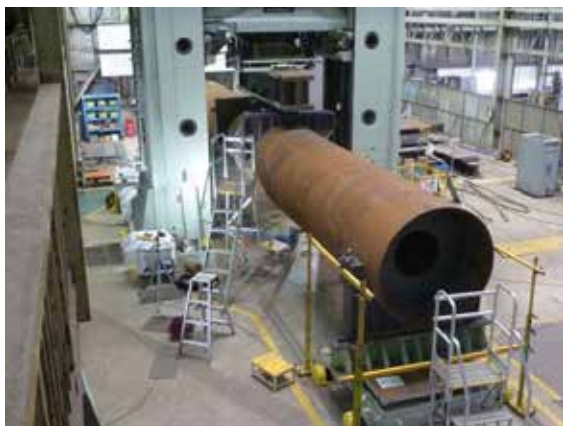
実大曲げ試験状況
