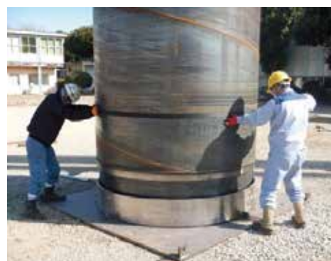
φ2000 JFE ネジール® の接合試験の様子
