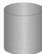
集水井(ライナープレート)
