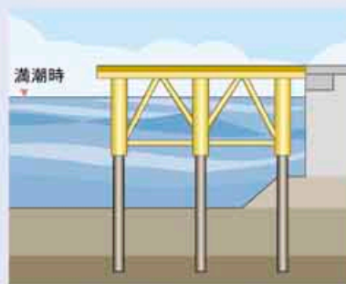
ジャケット工法でかさ上げ
