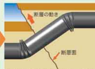
断層変位を曲げ変形で吸収した状態
