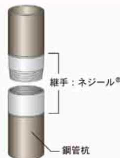
地すべり抑止杭
