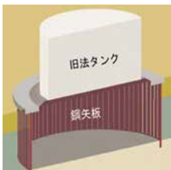
鋼矢板リング工法
