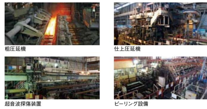
鋼片工場設備 [設備能力: 1,440千t/年]
