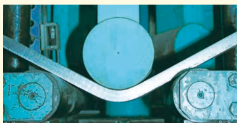
曲げ試験形状 (JIS Z 2248)
