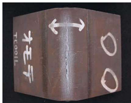
曲げ加工時の割れの例
