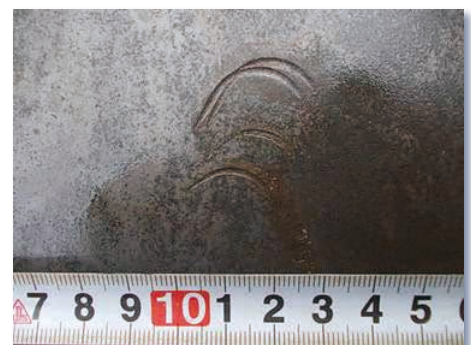
No.6の補足 加工装置の金具に残るきずの例
