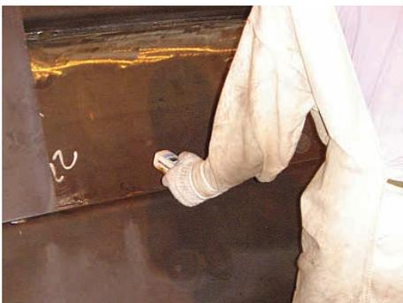
非接触型温度計を使った测温例
