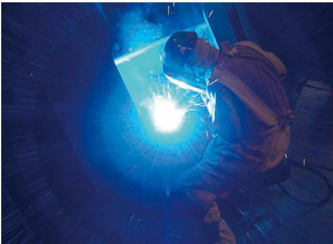
ガスマタルアーク溶接 (GMAW) ー炭酸ガスアーク溶接の例ー
