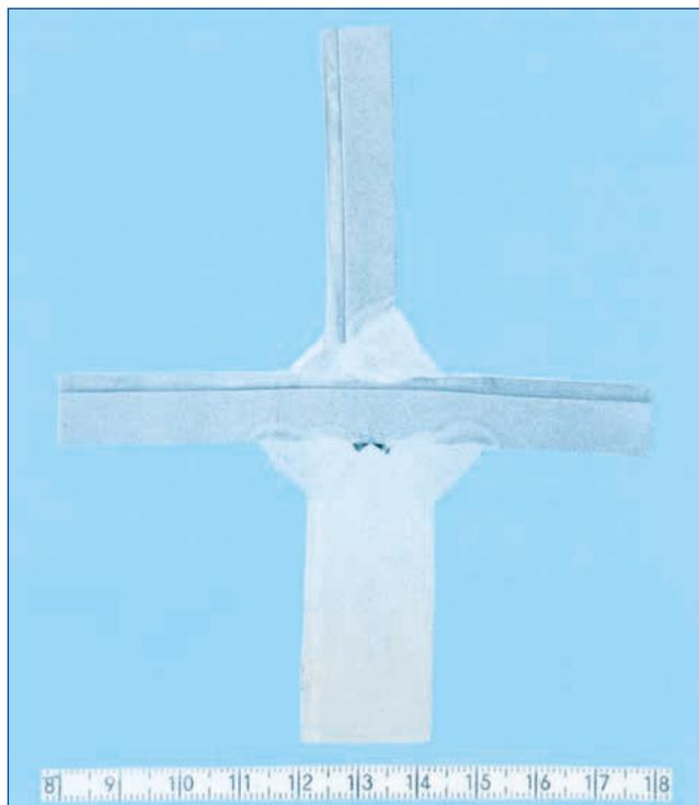
SM400B+SUS316Lの十字継手の断面マクロ写真
