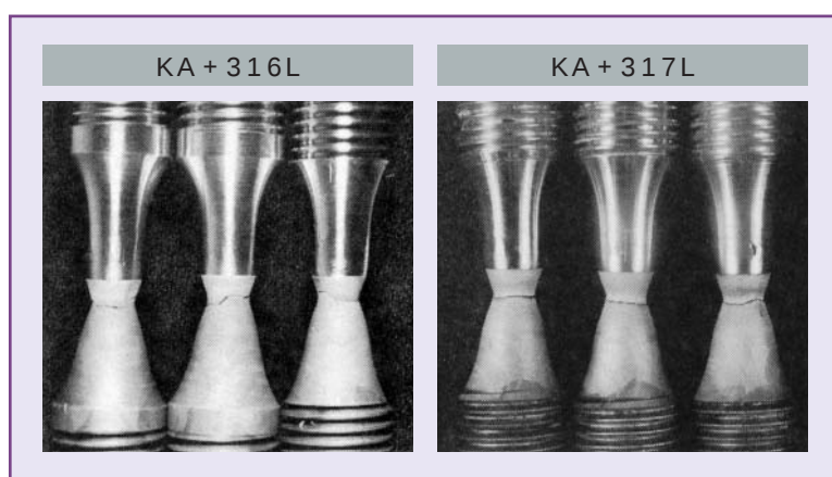
板厚方向引張試験後の外観（炭素鋼とステンレスの識別が出来るように腐食）
