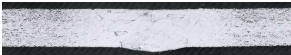
写真3 JFE434LN1、JFE434LN2(板厚1.0mm)溶接部の組織
