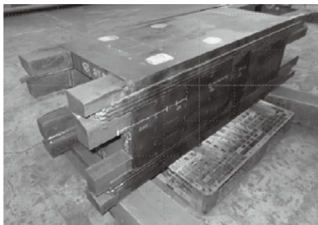
写真 1 HBL630 を用いたボックス柱サンプル
