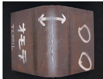
折弯加工时发生裂纹的示例
