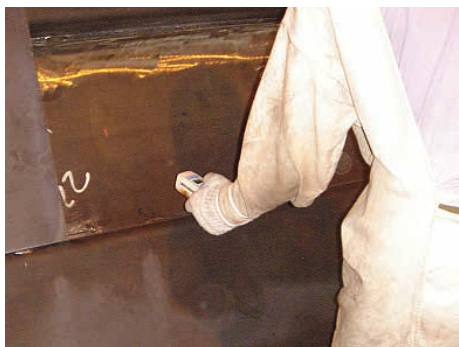
使用非接触式温度计的测温示例
