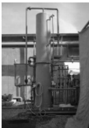
写真1 生物脱臭装置（フィールド試験用）
