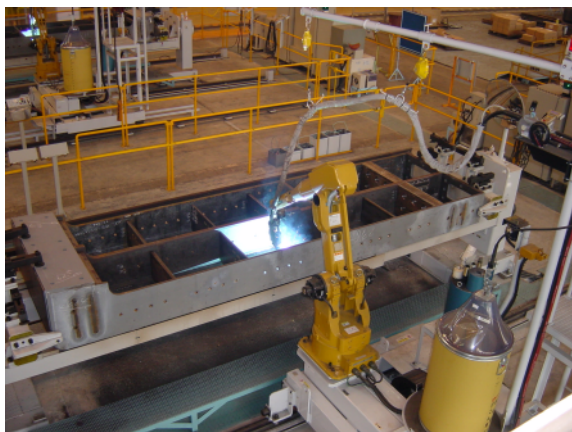
図10 ロボットによる溶接施工
