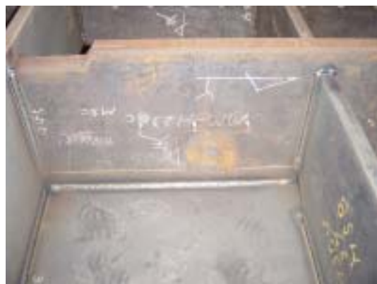
図11 柵目構造部分の溶接外観
