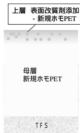
図2 食缶用新ラミネート鋼板の断面構造
