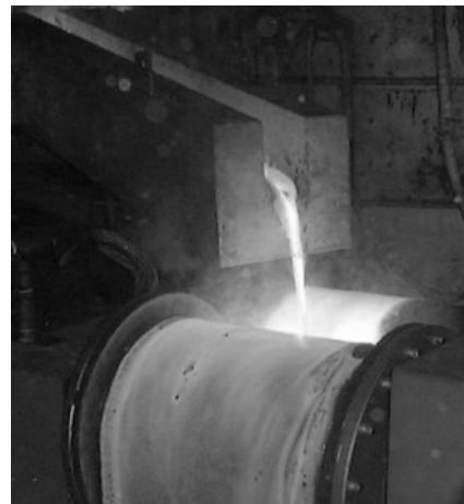
写真1 双ロール冷却試験
