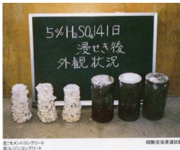
写真1 レジンコンクリートの耐酸性
